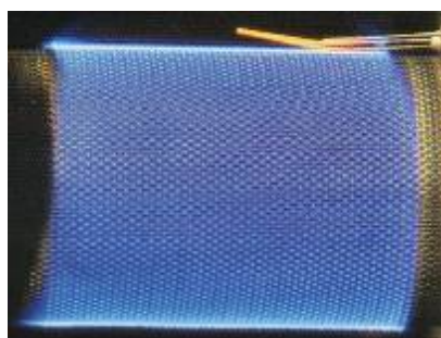
شکل ۲: شعله های بوجود آمده روی مشعل شعله خزه‌ای
